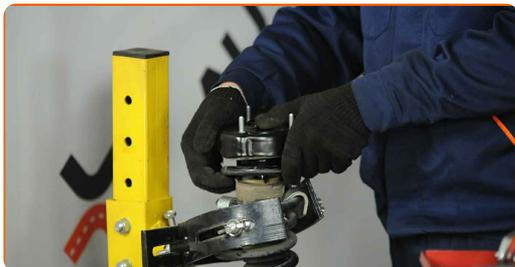
**25** Ziehen Sie die Federbeinkolbenstangenmutter an. Verwenden Sie Stecknuss Nr. 17. Verwenden Sie einen Drehmomentschlüssel. Ziehen Sie ihn mit 23 Nm Drehmoment fest.
