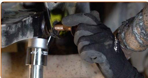
25 Entfernen Sie den Träger unter dem Arm.
