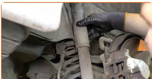
**19** Reinigen Sie die Stoßdämpferaufnahmen. Benutzen Sie eine Drahtbürste.
