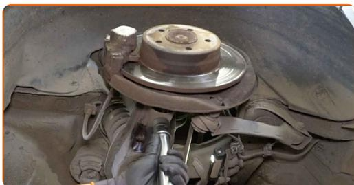
**13** Schrauben Sie den unteren Befestigungen des Stoßdämpfers ab. Verwenden Sie Ring-Gabelschlüssel Nr. 16. Verwenden Sie Stecknuss Nr. 16. Verwenden Sie einen Ratschenschlüssel.
