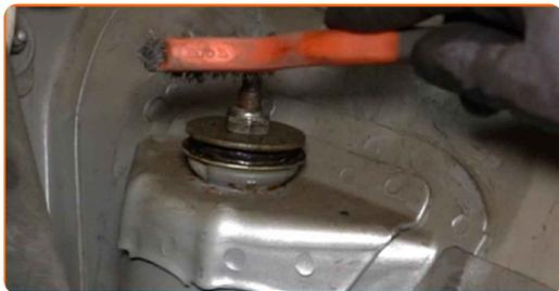
**5** Lockern Sie das obere Befestigungsgelelement des Stoßdämpfers. Verwenden Sie eine spezielle Schraubnuss, um den Stoßdämpfer zu entfernen Nr. 17. Verwenden Sie einen Stoßdämpfer Steckschlüsseinsatz Nr. DD5.2. Verwenden Sie einen Ratschenschlüssel.
