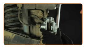
Behandeln Sie die Befestigungsschrauben. Verwenden Sie ein Dichtmittel.
