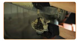
Behandeln Sie den Bremsschlauch. Benutzen Sie einen Bremsenreiniger.
