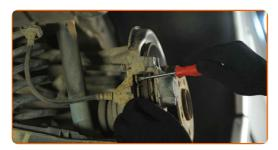
Entfernen Sie die Bremsbeläge. Verwenden Sie einen flachen Schraubendreher.
