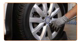
Entfernen Sie den Wagenheber sowie die Unterlegkeile.
