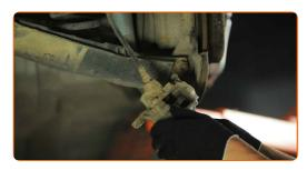
16 Trennen Sie den Bremsschlauch.
