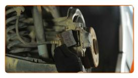
Klemmen Sie den Bremsschlauch ab, indem Sie eine geeignete Klemme einsetzen.
