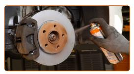
Die Bremsscheibenoberfläche reinigen. Benutzen Sie einen Bremsenreiniger.
