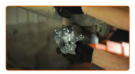
Entfernen Sie die Klammer des Bremsschlauchs.
