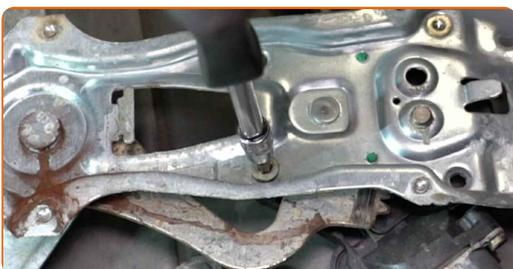
**30** Entfernen Sie den Motor des elektrischen Fensterhebers.
