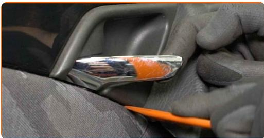
**7** Entfernen Sie die Abdeckung des Airbag-Systems. Verwenden Sie einen Zierleistenkeil.
