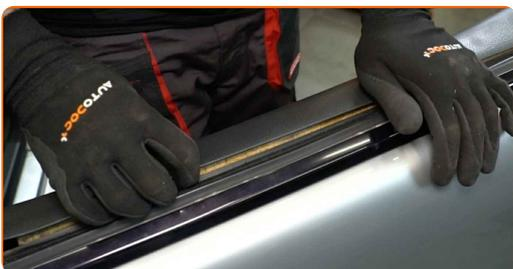
**53** Schrauben Sie die Befestigungen der Türinnenverkleidung ein. Verwenden Sie einen Kreuzschlitzschraubendreher.
