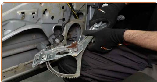
**28** Ziehen Sie die Steckverbindung aus dem Motor des elektrischen Fensterhebers.
