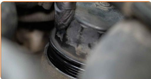
**26** Ziehen Sie den Ölfilterdeckel fest. Verwenden Sie Steckschlüssel 76-14F. Verwenden Sie einen Drehmomentschlüssel. Ziehen Sie ihn mit 25 Nm Drehmoment fest.
