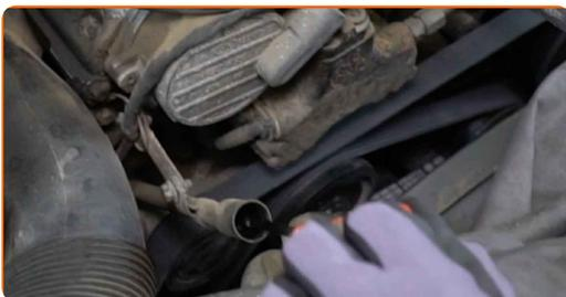
**4** Schrauben Sie die Öleinfüllschraube ab.
