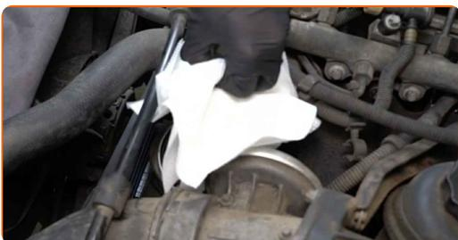
**25** Bauen Sie die Abdeckung des Ölfiltergehäuses ein und schrauben Sie diese ein.
