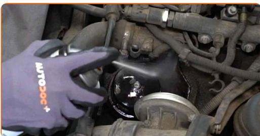
**6** Schrauben Sie den Filtergehäusedeckel zusammen mit dem alten Filterelement ab. Verwenden Sie Steckschlüssel 76-14F. Verwenden Sie einen Ratschenschlüssel.
