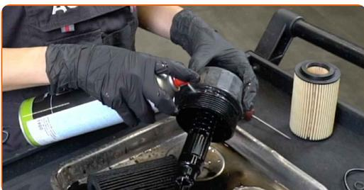
**18** Setzen Sie neue O-Ringe sowie einen neuen Ölfilter in deren Aufnahmen an der Filterabdeckung ein.
