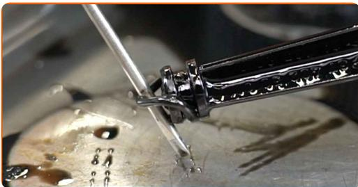
**16** Lösen Sie den Ölfilter vom Filterdeckel. Verwenden Sie einen flachen Schraubendreher.
