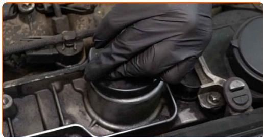
**32** Befestigen Sie den Deckel des Öleinfüllstutzens.
