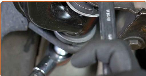
**32** Ziehen Sie die vordere Befestigung des Lenkers fest. Verwenden Sie Ring-Gabelschlüssel Nr. 22. Verwenden Sie Stecknuss Nr. 22. Verwenden Sie einen Drehmomentschlüssel. Ziehen Sie ihn mit 120 Nm Drehmoment fest.
