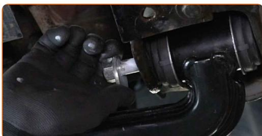
**28** Entfernen Sie die Stütze unter dem Querlenker.
