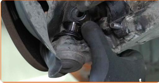
**17** Entfernen Sie die Befestigungsschrauben. Verwenden Sie einen Splintentreiber. Benutzen Sie einen Hammer.
