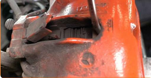
**13** Entfernen Sie den Bremssattel.
