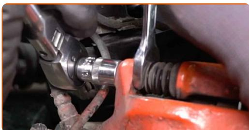
**11** Entfernen Sie die Befestigungsschrauben.
