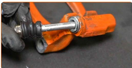
**42** Behandeln Sie die Bremssattel-Führungsstifte. Verwenden Sie das Bremssattelführungsbolzen-Fett.
