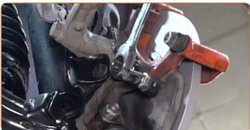
**25** Entfernen Sie die Befestigungsschrauben.
