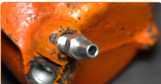
**45** Reinigen Sie den Bereich, in dem der Bremsschlauch mit dem Bremssattel verbunden ist. Benutzen Sie eine Drahtbürste. Verwenden Sie Allzweckreinigungsspray.
