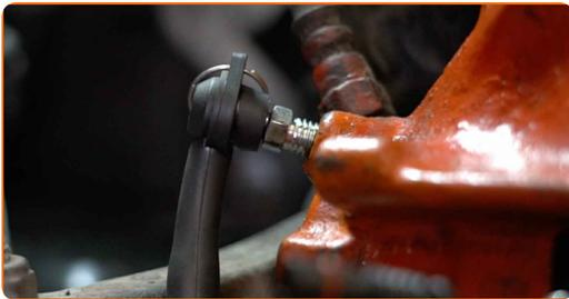
**59** Trennen Sie den Schlauch des Bremsentlüftungs-Kits.
