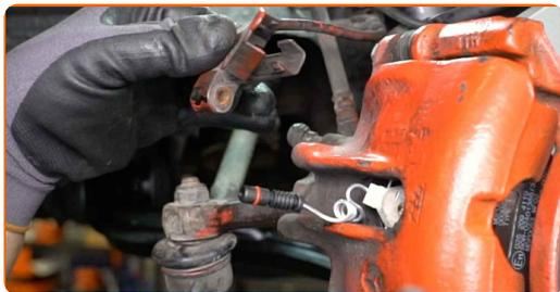
**13** Reinigen Sie den Montagesitz des Bremsschlauchs auf dem Bremssattel. Benutzen Sie eine Drahtbürste. Benutzen Sie WD-40-Spray.
