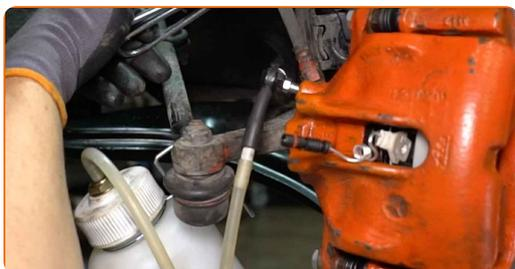
**56** Entfernen Sie die Bremsschlauchklemmen.
