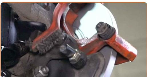
**24** Schrauben Sie die Befestigungen des Bremssattelhalters ab. Verwenden Sie Ring-Gabelschlüssel Nr. 19.
