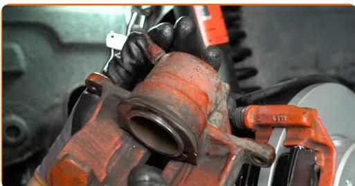
**21** Schrauben Sie den Bremsschlauch vom Bremssattel ab.
