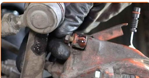
**12** Ziehen Sie den Stecker des Bremsbelagverschleißsensors ab.
