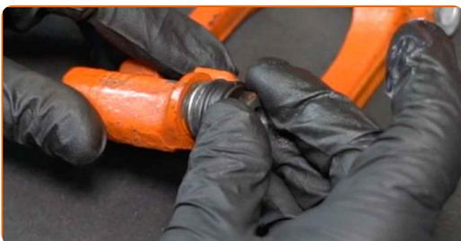
**44** Ziehen Sie die Bremsentlüftungsschraube an.
