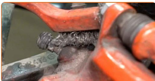
**14** Klemmen Sie den Bremsschlauch ab, indem Sie eine geeignete Klemme einsetzen.
