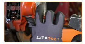
10 Entfernen Sie die Rückholfeder der Bremsbeläge.
