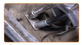
Montieren Sie neue Feststellbremsbacken.
