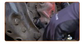
15 Entfernen Sie die Befestigungsschrauben.
