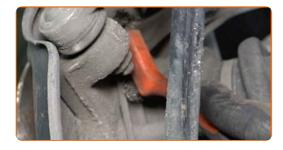
Lösen Sie die Schraube, mit der das Feststellbremsseil am hinteren Achsschenkel befestigt ist. Verwenden Sie Stecknuss Nr. 13. Verwenden Sie einen Ratschenschlüssel.
