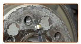
Lösen Sie den Bremskolbenrücksteller. Verwenden Sie einen flachen Schraubendreher.
