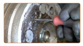
Entfernen Sie die Bremsscheibe.
