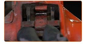
Verteilen Sie die Bremsbeläge. Benutzen Sie ein Brecheisen (2 Teile).
