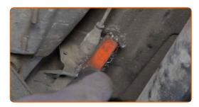
Entfernen Sie die Halterung, die das Feststellbremsseil mit der Karosserie verbindet. Benutzen Sie ein Brecheisen.
