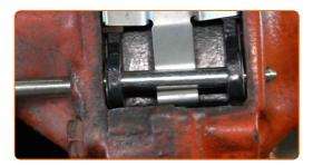
Die Bremsscheibenoberfläche reinigen. Benutzen Sie einen Bremsenreiniger.
