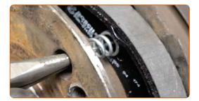
Bauen Sie die untere Rückstellfeder ein. Verwenden Sie einen flachen Schraubendreher.
