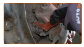
Schrauben Sie die Befestigungen des Bremssattels ab. Verwenden Sie Ring-Gabelschlüssel Nr. 17.
