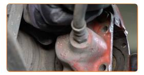
Entfernen Sie den Bremssattel.
