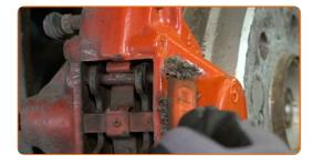
Entfernen Sie die Führungsbolzen der Bremsbeläge. Verwenden Sie einen Splintentreiber. Benutzen Sie einen Hammer.
