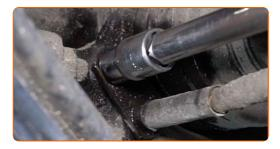
27 Entfernen Sie die Befestigungsschraube.
