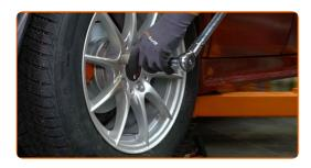
Entfernen Sie den Wagenheber sowie die Unterlegkeile.
