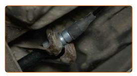
Montieren Sie die Halterung, die das Feststellbremsseil mit der Karosserie verbindet.
