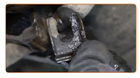
Entfernen Sie das Handbremsseil.
