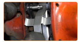
Montieren Sie die Führungsbolzen der Bremsbeläge. Verwenden Sie einen Splintentreiber. Benutzen Sie einen Hammer.
