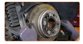
Entfernen Sie die untere Rückholfeder der Bremsbacke. Verwenden Sie einen flachen Schraubendreher.
