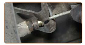
Reinigen Sie die Montagesitze des Handbremsseils. Benutzen Sie eine Drahtbürste. Verwenden Sie Allzweckreinigungsspray.
