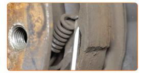
Entfernen Sie die Niederhaltefedern der Feststellbremsbacken. Verwenden Sie eine Spitzzange.
