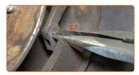
Entfernen Sie das Spreizschloss der Feststellbremse.
