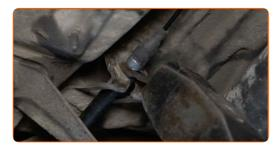
Bringen Sie den Stift an, der das Bremsseil mit dem Spreizschloss der Feststellbremse verbindet.
