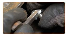
Montieren Sie das Spreizschloss der Feststellbremse.
