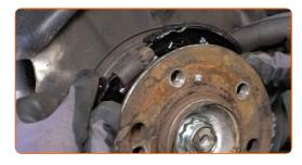
Montieren Sie die Niederhaltefedern der Feststellbremsbacken. Verwenden Sie eine Spitzzange.
