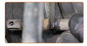
Reinigen Sie den Seillängenausgleich des Feststellbremsseils. Benutzen Sie eine Drahtbürste. Benutzen Sie WD-40-Spray.
