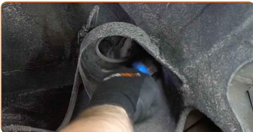
**34** Reinigen Sie die Stoßdämpferaufnahmen. Benutzen Sie eine Drahtbürste. Verwenden Sie Allzweckreinigungsspray.
