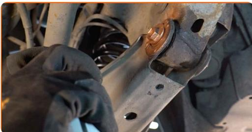
**24** Entfernen Sie den Träger unter der Achsschenkelachse.
