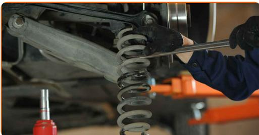
**15** Reinigen Sie die Aufnahmen der Spiralfedern. Benutzen Sie eine Drahtbürste. Benutzen Sie WD-40-Spray.
