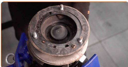
**43** Dekomprimieren Sie die Feder.
