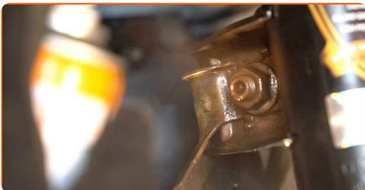
**61** Bauen Sie den Spurstangenkopf an dem Achsschenkel an.
