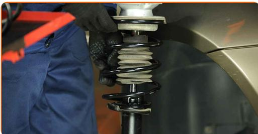
**46** Schrauben Sie die obere Befestigung des Federbeinbefestigung an.
