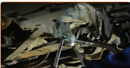
**58** Montieren Sie den Querlenker.
