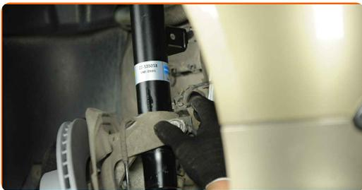
**56** Installieren Sie das hintere Befestigungselement des Querlenkers.
