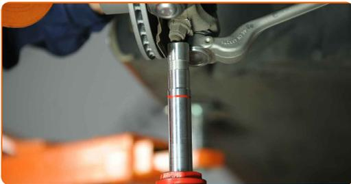
**64** Ziehen Sie das vordere Befestigungselement an, das den Querlenker mit dem Hilfsrahmen verbindet. Verwenden Sie Ring-Gabelschlüssel Nr. 18. Verwenden Sie einen Drehmomentschlüssel. Ziehen Sie ihn mit 68 Nm Drehmoment fest.+90°
