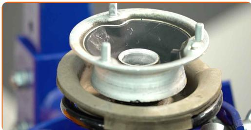
**41** Ziehen Sie die Federbeinkolbenstangenmutter an. Verwenden Sie Stecknuss Nr. 21. Verwenden Sie einen Drehmomentschlüssel. Ziehen Sie ihn mit 64 Nm Drehmoment fest.
