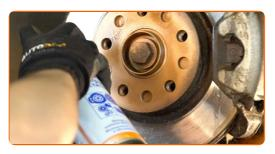
Die Bremsscheibenoberfläche reinigen. Benutzen Sie einen Bremsenreiniger.
