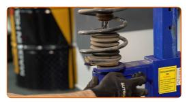
Entfernen Sie die Kappe des Federbeinstützlagers. Verwenden Sie einen flachen Schraubendreher.
