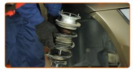
Stellen Sie das Dämpferbein auf das Federspannwerkzeug.
