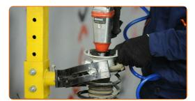
Entfernen Sie das obere Federbein. Verwenden Sie einen flachen Schraubendreher.
