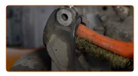
Befestigen Sie das Dämpferbein auf dem Achsschenkel. Verwenden Sie einen flachen Metallmeißel. Benutzen Sie einen Hammer.
