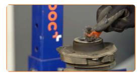
Entfernen Sie die Stangenmutter des Federkolben. Verwenden Sie Stecknuss Nr. 21. Verwenden Sie einen Ratschenschlüssel.
