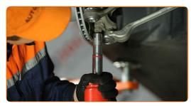
Ziehen Sie das vordere Befestigungselement an, das den Querlenker mit dem Hilfsrahmen verbindet. Verwenden Sie Ring-Gabelschlüssel Nr. 18. Verwenden Sie einen Drehmomentschlüssel. Ziehen Sie ihn mit 68 Nm Drehmoment fest.+90°
