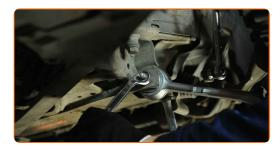
62 Montieren Sie den Querlenker.
