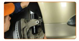
Ziehen Sie die unteren Befestigungen an, die das Federbein mit dem Achsschenkel verbinden. Verwenden Sie Ring-Gabelschlüssel Nr. 18. Verwenden Sie Stecknuss Nr. 18. Verwenden Sie einen Drehmomentschlüssel. Ziehen Sie ihn mit 81 Nm Drehmoment fest.
