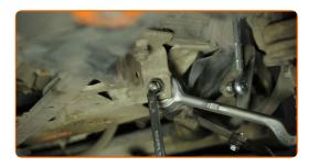
Lösen Sie die hintere Befestigung des Querlenkers.
