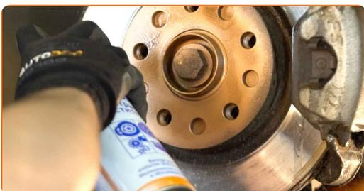
**15** Reinigen Sie die Oberfläche an welcher die Felge montiert werden soll. Benutzen Sie einen Bremsenreiniger.
