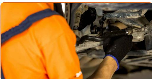
**12** Ziehen Sie das Befestigungselement an, das die Druckstange mit dem Federbein verbindet. Verwenden Sie Ring-Gabelschlüssel Nr. 16. Verwenden Sie Stecknuss Nr. 17. Verwenden Sie einen Drehmomentschlüssel. Ziehen Sie ihn mit 60 Nm Drehmoment fest.
