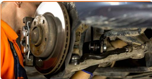
**11** Ziehen Sie das Befestigungselement an, das die Druckstange mit dem Stabilisator verbindet. Verwenden Sie Ring-Gabelschlüssel Nr. 16. Verwenden Sie Stecknuss Nr. 17. Verwenden Sie einen Drehmomentschlüssel. Ziehen Sie ihn mit 60 Nm Drehmoment fest.
