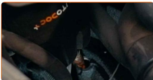
**4** Schrauben Sie die Öleinfüllschraube ab.
