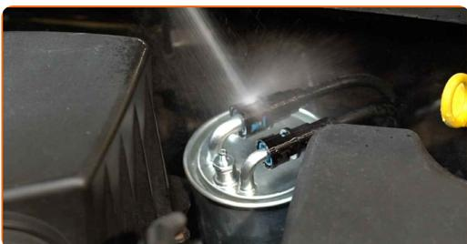
**7** Trennen Sie die Kraftstoffversorgungsleitungen vom Kraftstofffilter. Verwenden Sie Kraftstoffleitungenangen.
