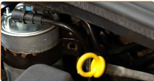
**5** Entfernen Sie den Kraftstofffilter.
