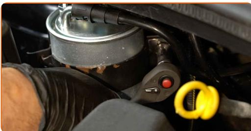
**4** Entfernen Sie die Befestigungsschraube.
