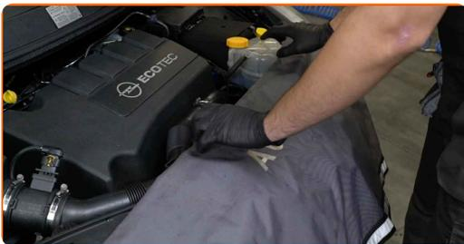
**3** Schrauben Sie die Halterung des Kraftstofffilters ab. Verwenden Sie Stecknuss Nr. 10. Verwenden Sie einen Ratschenschlüssel.
