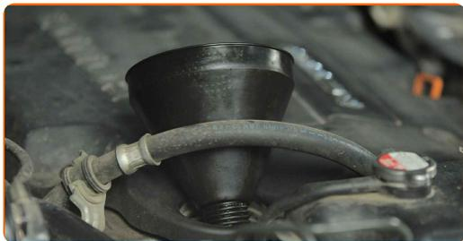
**24** Füllen Sie Öl durch den Einfüllstutzen in den Motor. Erforderliche Menge an Öl: 5.5 l.
