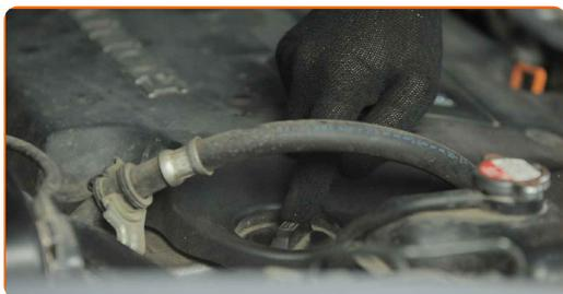
**22** Entfernen Sie die Öleinfüllschraube.
