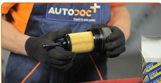
**20.1** Befestigen Sie die Abdeckung des Ölfiltergehäuses.
