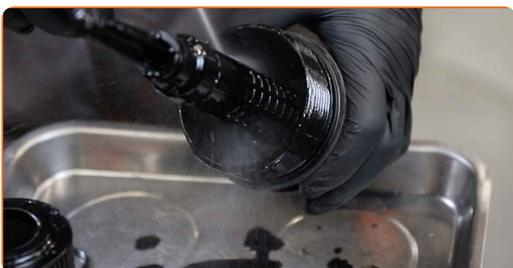
**17** Setzen Sie neue O-Ringe sowie einen neuen Ölfilter in deren Aufnahmen an der Filterabdeckung ein. Verwenden Sie einen flachen Schraubendreher.
