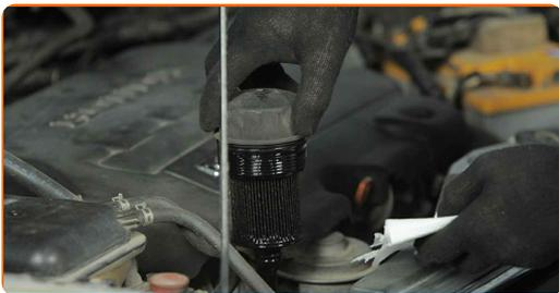
**14** Lösen Sie den Ölfilter vom Filterdeckel.
