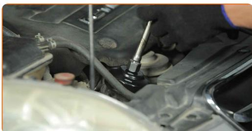
**21** Schrauben Sie die Öleinfüllschraube ab.
