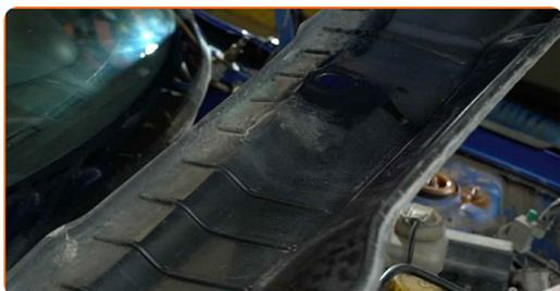
**14** Drücken Sie auf die Halteclips des Pollenfilters, um sie zu lösen.
