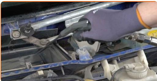
**18** Setzen Sie ein neues Filterelement in das Filtergehäuse.
