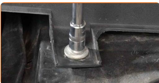
25 Bauen Sie die Dichtung der Windabweiserabdeckung ein.
