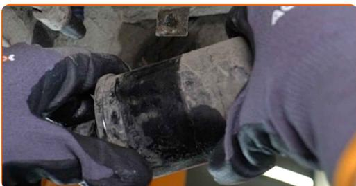
**9** Trennen Sie die Kraftstoffversorgungsleitungen vom Kraftstofffilter. Verwenden Sie Kraftstoffleitungszangen.
