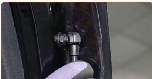
**10** Lösen Sie den Sicherungsring, der die Gasfeder mit dem Kofferraumdeckel verbindet. Verwenden Sie einen flachen Schraubendreher.
