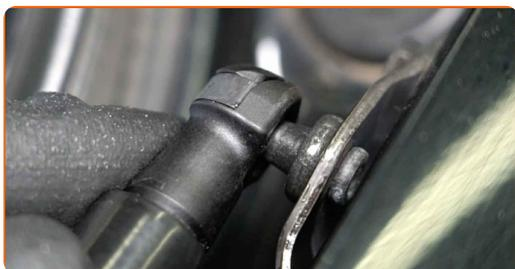
**9** Lassen Sie den Sprengring, der die Gasfeder mit dem Kofferraumdeckel verbindet, einrasten.
