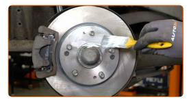
Die Bremsscheibenoberfläche reinigen. Benutzen Sie einen Bremsenreiniger.
