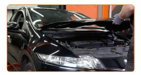
Entfernen Sie die Dichtung der Windabweiserabdeckung.
