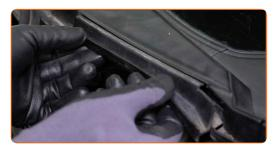
Bauen Sie die Dichtung der Windabweiserabdeckung ein.
