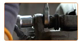
Entfernen Sie die Befestigungsschrauben.
