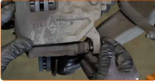
**23** Ziehen Sie die Bremssattelbefestigungen fest. Verwenden Sie Ring-Gabelschlüssel Nr. 17. Verwenden Sie Stecknuss Nr. 13. Verwenden Sie einen Drehmomentschlüssel. Ziehen Sie ihn mit 35 Nm Drehmoment fest.
