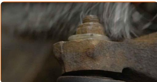
**30** Lösen Sie das Ende der Befestigungsmutter an dem Achsschenkel. Verwenden Sie Stecknuss Nr. 17. Verwenden Sie einen Ratschenschlüssel.
