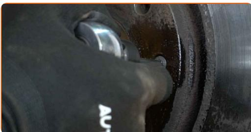
**18** Entfernen Sie die Befestigungsschrauben.
