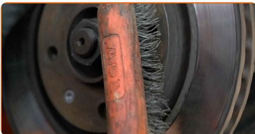
**17** Schrauben Sie die Bremsscheibenbefestigungen ab. Verwenden Sie den Torx T30. Verwenden Sie einen Ratschenschlüssel.
