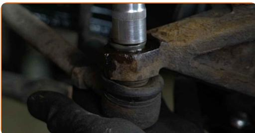
**31** Ziehen Sie den Spurstangenkopf vom Achsschenkel. Verwenden Sie einen Kugelgelenkabzieher.
