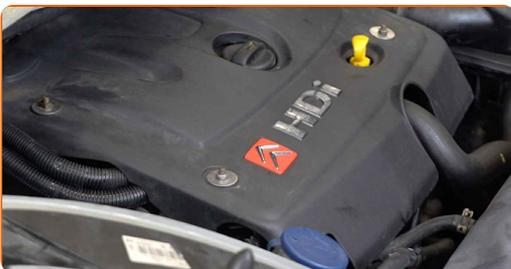
**24** Überprüfen Sie den Ölstand 5 Minuten nach dem Anhalten des Motors, verwenden Sie einen Peilstab und fügen Sie - wenn nötig - Öl hinzu.
