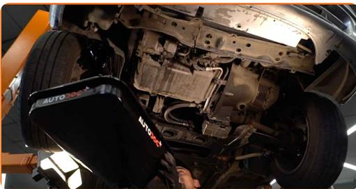
**8** Reinigen Sie den Bereich um die Ablassöffnung der Ölwanne. Benutzen Sie eine Drahtbürste. Verwenden Sie Allzweckreinigungsspray.
