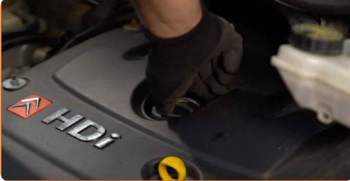
**23** Lassen Sie den Motor ein paar Minuten laufen. Nachdem die Ölstands-Warnleuchte erloschen ist, stoppen Sie den Motor.
