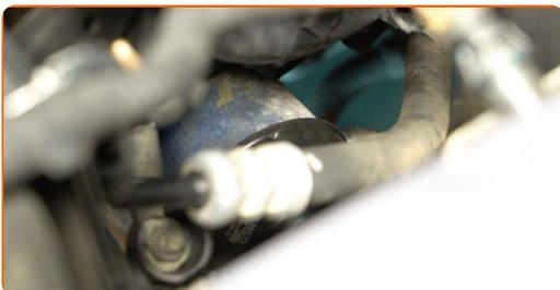
**5** Bereiten Sie einen Behälter für den alten Ölfilter vor. Legen Sie den alten Ölfilter in den Behälter.
