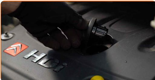
**4** Schrauben Sie den Ölfilter ab. Verwenden Sie Steckschlüssel 74/76-15F.
