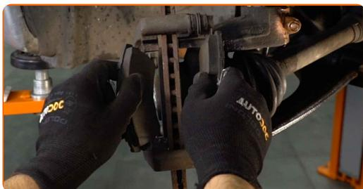
Austausch: Bremsbeläge – CITROËN C4 Stufenheck L. AUTODOC-Experten empfehlen:
