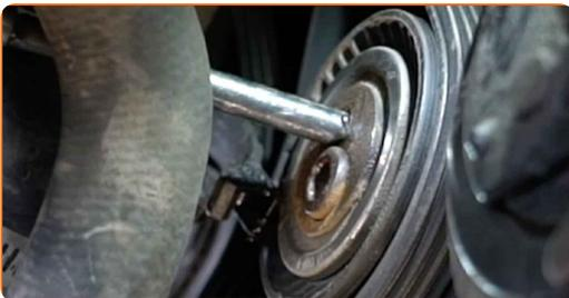
14 Entfernen Sie den Keilrippenriemen.
