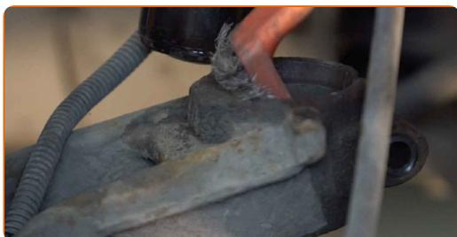
**47** Befestigen Sie das Dämpferbein auf dem Achsschenkel.
