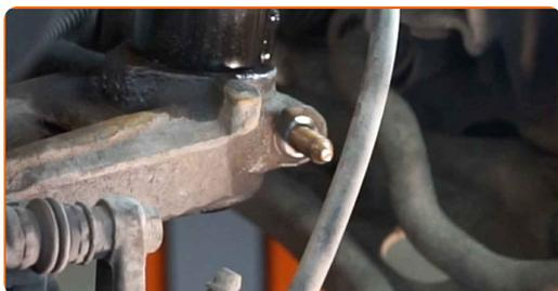
**49** Schrauben Sie das Befestigungselement ein, das das Federbein mit dem Achsschenkel verbindet. Verwenden Sie Stecknuss Nr. 16.
