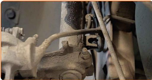
**15** Schrauben Sie das Befestigungselement heraus, das die Druckstange mit dem Federbein verbindet. Verwenden Sie Ring-Gabelschlüssel Nr. 17. Verwenden Sie den Torx T30. Verwenden Sie einen Ratschenschlüssel.
