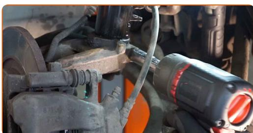
**50** Entfernen Sie den Träger unter dem Achsschenkel.
