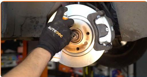
**65** Die Bremsscheibenoberfläche reinigen. Benutzen Sie einen Bremsenreiniger.
