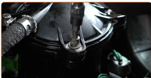
**12** Reinigen Sie die Abdeckung und das Gehäuse des Kraftstofffilters. Verwenden Sie Allzweckreinigungsspray.
