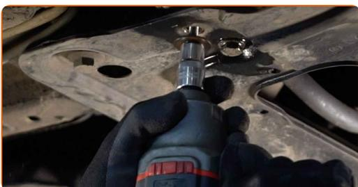
**14** Lösen Sie die hintere Befestigung des Querlenkers.
