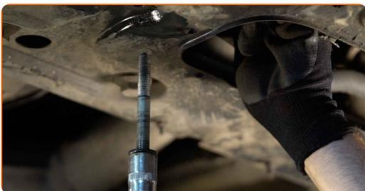
**15** Entfernen Sie die vordere Befestigung des Querlenkers.
