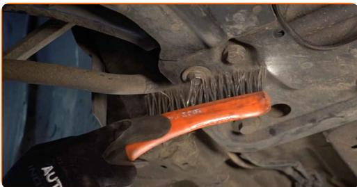
**13** Schrauben Sie das hintere Befestigungselement heraus, das den Querlenker mit dem Hilfsrahmen verbindet. Verwenden Sie Stecknuss Nr. 13. Verwenden Sie Stecknuss Nr. 16. Verwenden Sie ein Windeisen.
