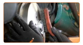
Behandeln Sie die Oberfläche, an der die Radfelge die Bremstrommel berührt. Verwenden Sie Keramikfett.
