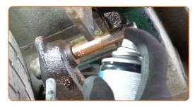
Platzieren Sie den Stoßdämpfer im Radkasten und befestigen Sie ihn.
