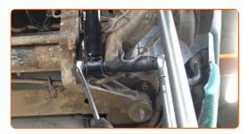
Ziehen Sie die obere Stoßdämpferbefestigung an. Verwenden Sie Stecknuss Nr. 24. Verwenden Sie einen Drehmomentschlüssel. Ziehen Sie ihn mit 110 Nm Drehmoment fest.
