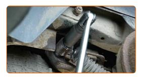
Schrauben Sie den unteren Befestiger des Stoßdämpfers ab. Verwenden Sie Ring-Gabelschlüssel Nr. 24. Verwenden Sie Stecknuss Nr. 24. Verwenden Sie einen Ratschenschlüssel.
