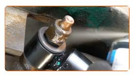
Reinigen Sie die Oberfläche an welcher die Felge montiert werden soll. Benutzen Sie eine Drahtbürste.
