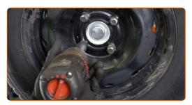
Senken Sie das Auto und ziehen Sie die Radschrauben über Kreuz an. Verwenden Sie eine Schlagnuss für Felgen # 19. Verwenden Sie einen Drehmomentschlüssel. Ziehen Sie ihn mit 90 Nm Drehmoment fest.
