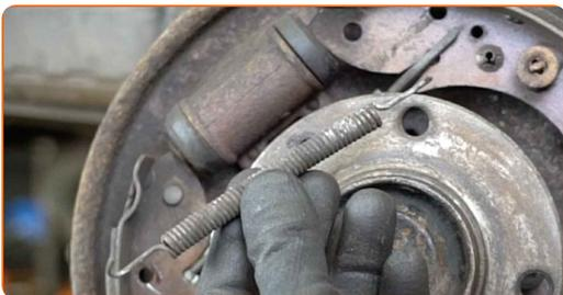
**18** Entfernen Sie die Halterung der Trommelbremsbacken. Verwenden Sie ein Bremsfeder-Montagewerkzeug.
