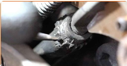
**17** Entfernen Sie die obere Rückholfeder der Bremsbacken. Verwenden Sie einen flachen Schraubendreher.
