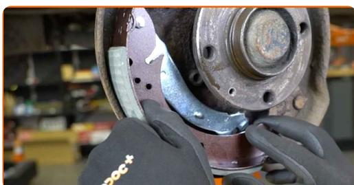
**28** Installieren Sie die Halterung der Trommelbremsbacken. Verwenden Sie ein Werkzeug für Bremsträgerfedern.
