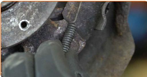
**14** Entfernen Sie die seitliche Haltefeder. Verwenden Sie eine Spitzzange.
