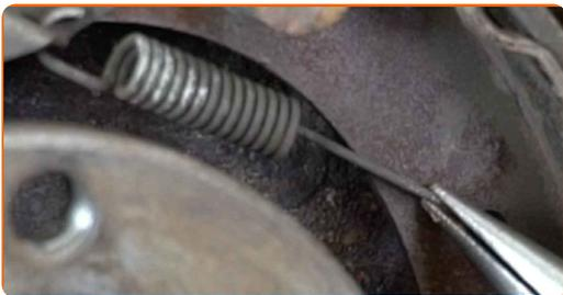
**15** Entfernen Sie den Einstellhebel.
