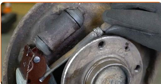
**30** Installieren Sie eine neue rechte Bremsbacke.
