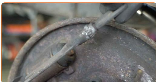
**21** Entfernen Sie die Feststellbremsen-Haltefeder der linken Bremsbacke. Verwenden Sie einen flachen Schraubendreher.
