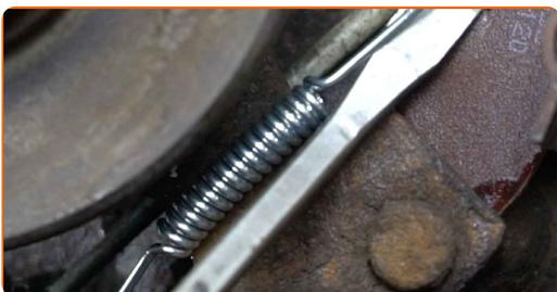
**35** Installieren Sie die Feststellbremsen-Haltefeder der linken Bremsbacke.
