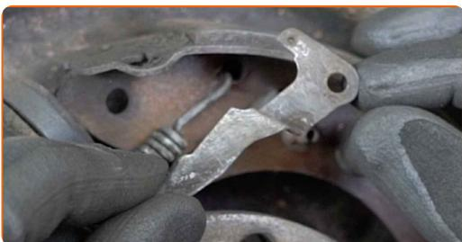
**16** Lösen Sie den Nachsteller der Bremsbacken. Verwenden Sie einen flachen Schraubendreher.
