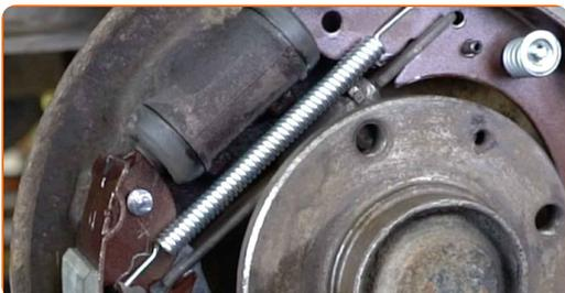
**32** Montieren Sie den Einstellhebel.
