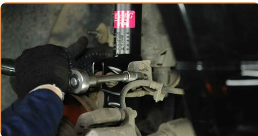
51 Montieren Sie den Querlenker.
