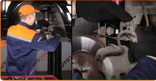
50 Ziehen Sie die Befestigung an, die die Halterung des Bremsschlauchs mit dem Federbein verbindet. Verwenden Sie Stecknuss Nr. 13. Verwenden Sie einen Ratschenschlüssel.
