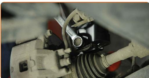
49 Installieren Sie die Halterung des Bremsschlauchs.
