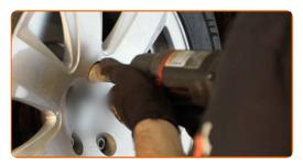
Senken Sie das Auto und ziehen Sie die Radschrauben über Kreuz an. Verwenden Sie einen Drehmomentschlüssel. Ziehen Sie ihn mit 120 Nm Drehmoment fest.
