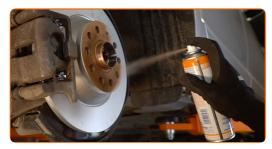
Die Bremsscheibenoberfläche reinigen. Benutzen Sie einen Bremsenreiniger.
