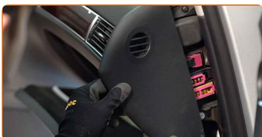
**5** Lösen Sie die Befestigungsschrauben des Handschuhfaches ab. Verwenden Sie Stecknuss Nr. 8. Verwenden Sie einen Ratschenschlüssel.
