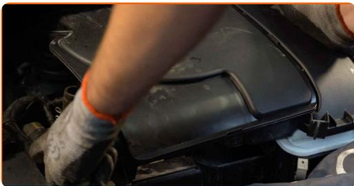
**23** Bringen Sie die Befestigungsklemmen der Entlüftungsleitung des Luftfilters und der Zuleitung des Luftfilters an. Verwenden Sie eine Clic-R-Kragenzange.
