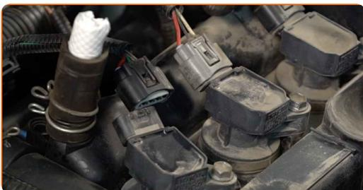
**8** Reinigen Sie die Zündspulen. Benutzen Sie WD-40-Spray.
