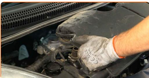
**6** Bedecken Sie die Drosselklappe mit einem Mikrofasertuch, um zu vermeiden, dass Staub und Schmutz in das System gelangen.
