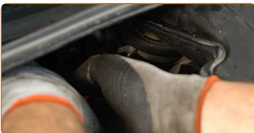
**4** Lösen Sie die Befestigungsclips der Luftfilterabdeckung.
