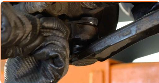
**11** Schrauben Sie die vordere Armbefestigung ab. Verwenden Sie Stecknuss Nr. 17. Verwenden Sie ein Windeisen.
