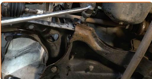
**12** Schrauben Sie das hintere Befestigungselement heraus, das den Querlenker mit dem Hilfsrahmen verbindet. Verwenden Sie Stecknuss Nr. 17. Verwenden Sie ein Windeisen.
