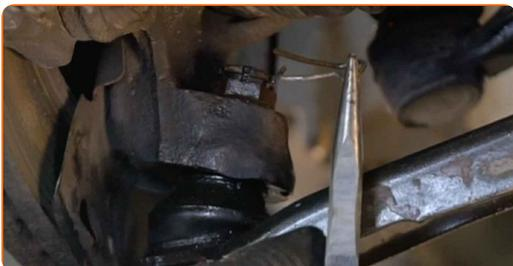
**10** Schrauben Sie die Kugelgelenkbefestigung vom Achsschenkel ab. Verwenden Sie Ring-Gabelschlüssel Nr. 17.
