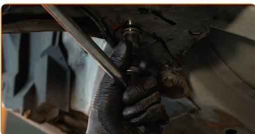
**13** Lösen Sie die hintere Befestigung des Querlenkers. Verwenden Sie Stecknuss Nr. 17.
