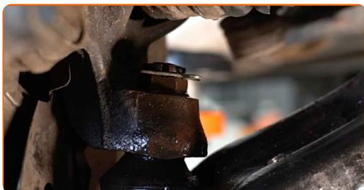
**68** Schrauben Sie das Befestigungselement ein, das den Stabilisator mit dem Querlenker verbindet. Verwenden Sie Ring-Gabelschlüssel Nr. 12. Verwenden Sie Stecknuss Nr. 12. Verwenden Sie einen Ratschenschlüssel.
