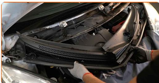
**10** Schrauben Sie die Befestigungen der Scheibenwischer Verkleidung ab. Verwenden Sie Stecknuss Nr. 10. Verwenden Sie einen Ratschenschlüssel.
