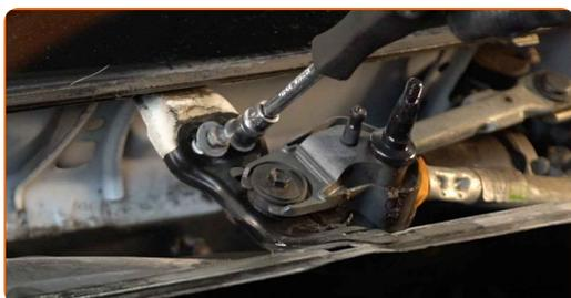
**11** Lösen Sie den Steckverbinder des Scheibenwischer Motors.
