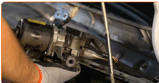
**12** Entfernen Sie die Verkleidung, die mit dem Wischergestänge verbunden ist.
