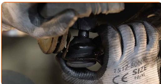
**66** Ziehen Sie das Kugelgelenk an. Verwenden Sie Ring-Gabelschlüssel Nr. 19. Verwenden Sie einen Drehmomentschlüssel. Ziehen Sie ihn mit 98 Nm Drehmoment fest.
