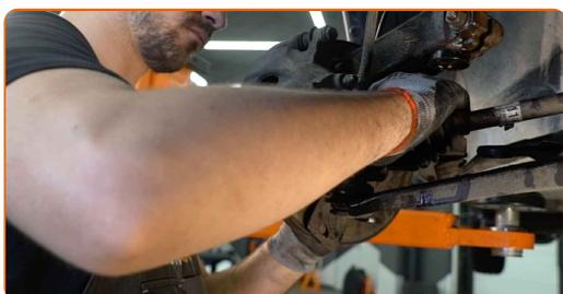
**65** Verbinden Sie den Unterarm mit dem Achsschenkel.
