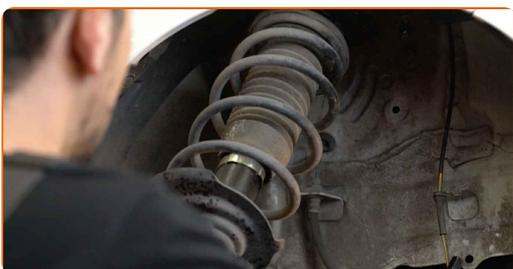
**43** Stellen Sie das Dämpferbein auf das Federspannwerkzeug.
