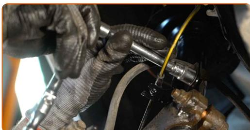
**74** Verbinden Sie das ABS mit der Sensorverdrahtung.
