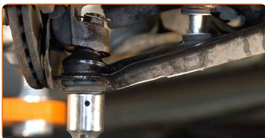
**70** Ziehen Sie das Befestigungselement an, das den Stabilisator mit dem Querlenker verbindet. Verwenden Sie Stecknuss Nr. 12. Verwenden Sie einen Drehmomentschlüssel. Ziehen Sie ihn mit 18 Nm Drehmoment fest.
