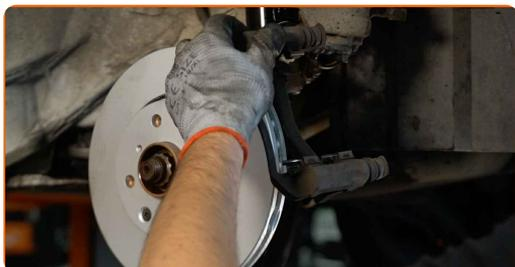
**23** Befestigen Sie die Bremssattelhalterung. Verwenden Sie Stecknuss Nr. 17. Verwenden Sie einen Drehmomentschlüssel. Ziehen Sie ihn mit 89 Nm Drehmoment fest.
