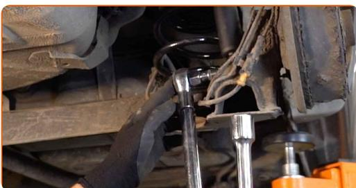
**26** Die Montage unter dem Hinterachsträger entfernen.
