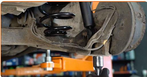
**25** Ziehen Sie den unteren Befestiger des Stoßdämpfers an. Verwenden Sie Stecknuss Nr. E14. Verwenden Sie einen Drehmomentschlüssel. Ziehen Sie ihn mit 110 Nm Drehmoment fest.
