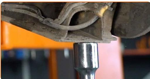
**23** Schrauben Sie das untere Befestigungselement des Stoßdämpfers ein. Verwenden Sie Stecknuss Nr. E14.
