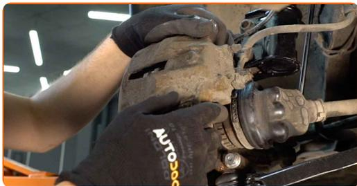
**18** Ziehen Sie die Bremssattelbefestigungen fest. Verwenden Sie Stecknuss Nr. 12. Verwenden Sie einen Drehmomentschlüssel. Ziehen Sie ihn mit 27 Nm Drehmoment fest.
