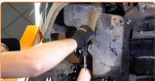
**18** Bringen Sie die Befestigungselemente der Radkastenabdeckung an und ziehen Sie diese an. Verwenden Sie den Torx T20.
