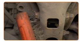
Schrauben Sie den unteren Befestiger des Stoßdämpfers ab. Verwenden Sie den Torx E14. Verwenden Sie Stecknuss Nr. 16. Verwenden Sie einen Ratschenschlüssel.
