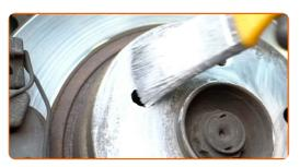
Die Bremsscheibenoberfläche reinigen. Benutzen Sie einen Bremsenreiniger.
