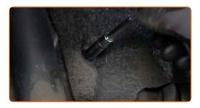
Den Stoßdämpfer entfernen.
