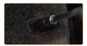
Reinigen Sie die untere Stoßdämpferbefestigung. Benutzen Sie ein Kupferschmiermittel.
