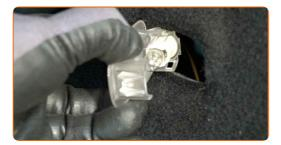
Schrauben Sie das Befestigungselement ab und entfernen Sie die Verzurröse aus dem Kofferraum. Verwenden Sie den Torx T40. Verwenden Sie einen Ratschenschlüssel.
