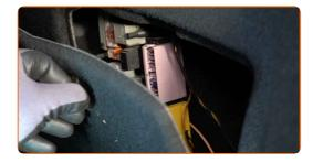
Entfernen Sie die Kofferraumseitenleuchte. Verwenden Sie einen Lösehebel, um die Clips zu entfernen.
