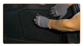
Montieren Sie die Verzurröse im Kofferraum und ziehen Sie sie fest. Verwenden Sie den Torx T40. Verwenden Sie einen Drehmomentschlüssel. Ziehen Sie ihn mit 15 Nm Drehmoment fest.
