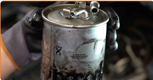
**14** Installieren Sie einen neuen Kraftstofffilter.
