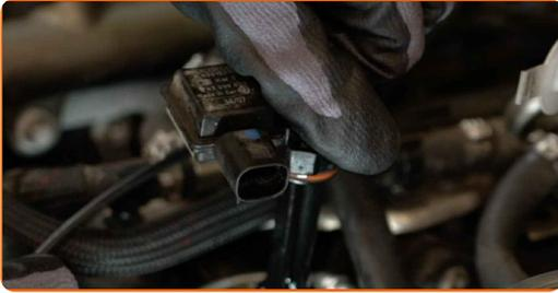
**12** Lösen Sie die Halterung des Kraftstofffilters. Benutzen Sie ein Brecheisen.
