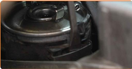
**13** Entfernen Sie den Kraftstofffilter.
