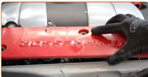
**5** Schrauben Sie die Befestigungsschrauben der Zündspulen ab. Verwenden Sie Stecknuss Nr. E8.
