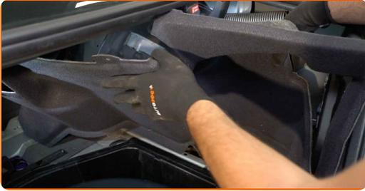
**42** Bringen Sie die Clips der Seitenauskleidung des Kofferraums an.
