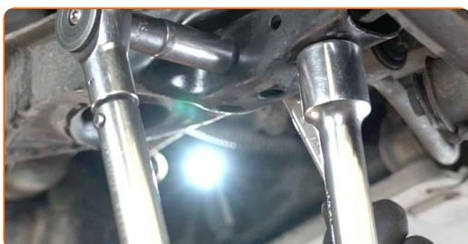
**28** Entfernen Sie den Träger unter dem Arm.
