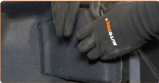
**44** Bringen Sie die zentrale Schutzverkleidung aus Kunststoff an.
