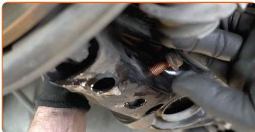
**25** Schrauben Sie das untere Befestigungselement des Stoßdämpfers ein. Verwenden Sie Ring-Gabelschlüssel Nr. 16. Verwenden Sie Stecknuss Nr. 16. Verwenden Sie einen Ratschenschlüssel.
