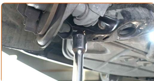
**27** Ziehen Sie den unteren Befestiger des Stoßdämpfers an. Verwenden Sie Ring-Gabelschlüssel Nr. 16. Verwenden Sie Stecknuss Nr. 16. Verwenden Sie einen Drehmomentschlüssel. Ziehen Sie ihn mit 55 Nm Drehmoment fest.
