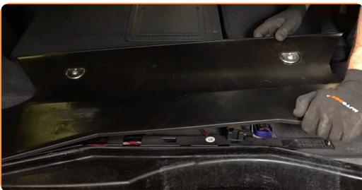
**45** Schrauben Sie das Befestigungselement der zentralen Schutzverkleidung aus Kunststoff ein. Verwenden Sie den Torx T40. Verwenden Sie einen Drehmomentschlüssel. Ziehen Sie ihn mit 11 Nm Drehmoment fest.
