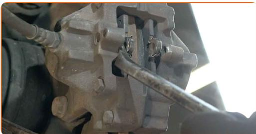
**11** Entfernen Sie die Bremsbeläge.
