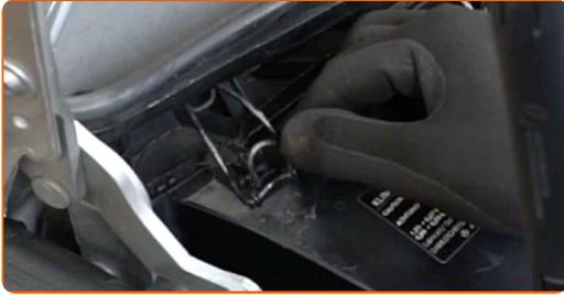
**4** Entfernen Sie den Gehäusedeckel des Innenraumfilters.
