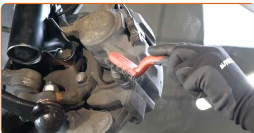
**9** Schrauben Sie die Befestigung des Bremssattels ab. Verwenden Sie Stecknuss Nr. 12. Verwenden Sie einen Ratschenschlüssel.
