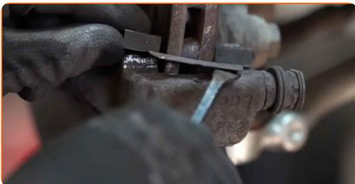
19 Entfernen Sie die Führungsstifte aus dem Bremssattel.
