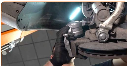
31 Bremssattelbefestigung einschrauben.
