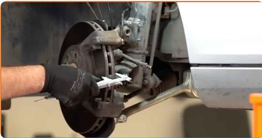
21 Entfernen Sie das alte Schmiermittel und Rückstände von Rost, falls es diese gibt, vom Bremssattel, den Bremssattelführungsbolzen sowie den Schutzhüllen. Benutzen Sie einen Bremsenreiniger.
